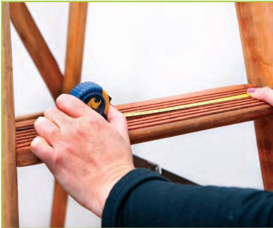
**1** Mesurez la largeur des barreaux de votre échelle et découpez vos planches en fonction. Les dimensions indiquées en p. 25 sont données à titre indicatif. Adaptez-les si besoin. Les profondeurs restent les mêmes.
